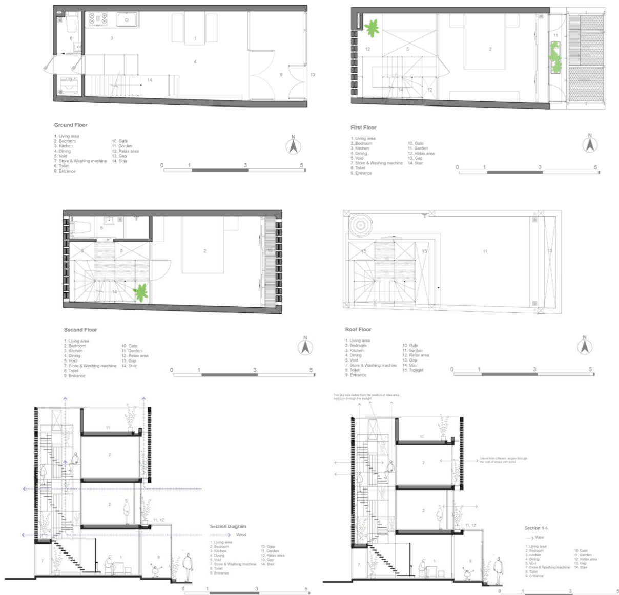
Figuras 22, 23, 24, 25 e 26: Casa Wasp, Ho Chi Minh, Vietnã, 2015. Planta térreo, primeiro pavimento, segundo pavimento e cobertura, corte com esquema da ventilação natural e corte com as visuais. Fonte: Quang Dam (2015)
